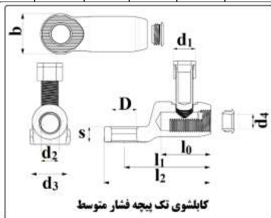
جدول شماره (۱۱) ابعاد کابلشوی پیچی فشار متوسط (mm)
